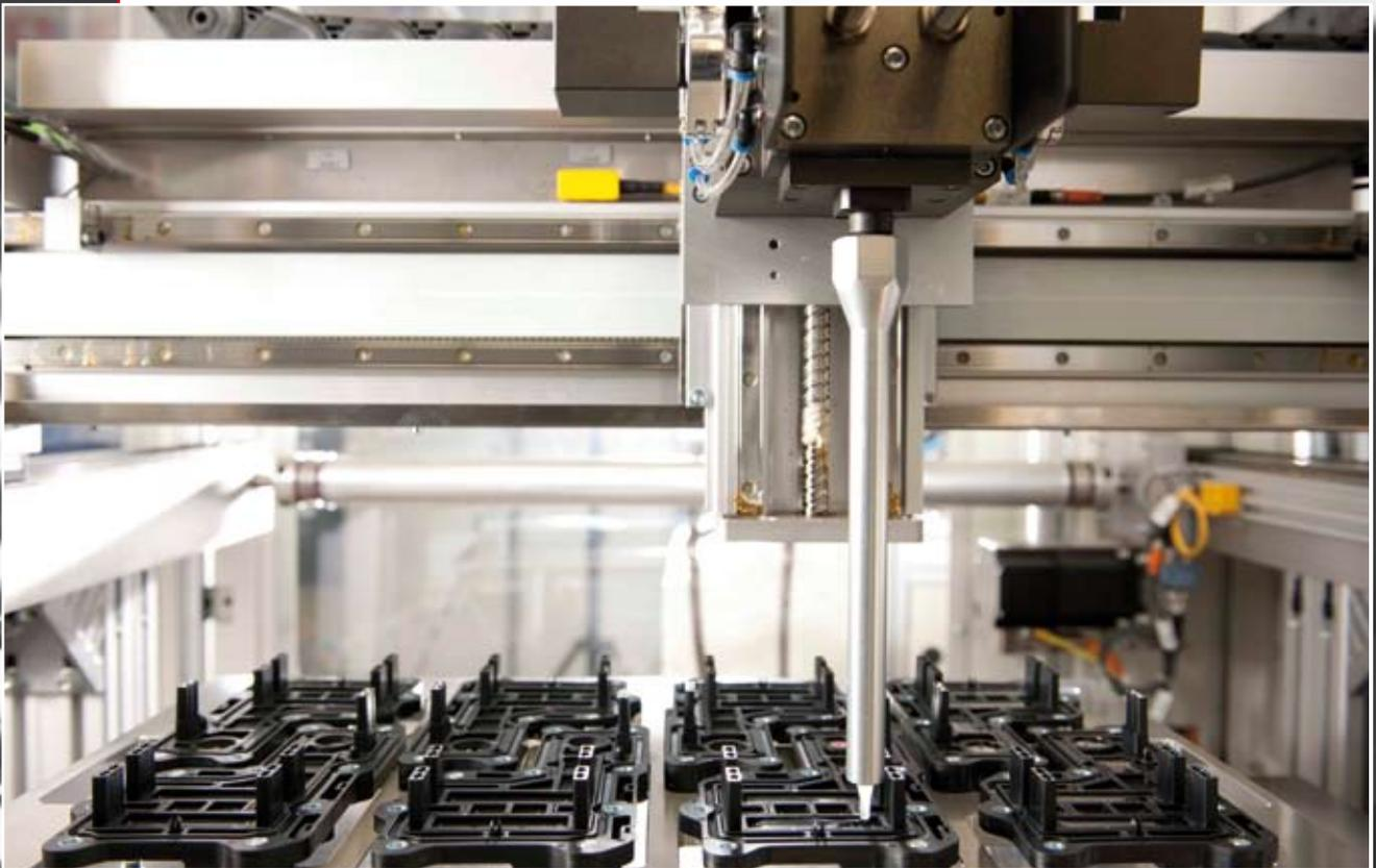
Vergießen ist das Aufbringen einer flüssigen 1- oder 2-Komponenten Vergussmasse in Aussparungen der Leerräume einer Leiterplatte oder eines Gehäuses.
