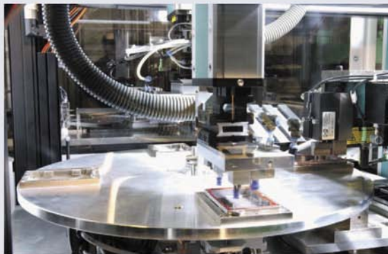
Prüfautomat für Xenon-Lichtsteuergeräte.
