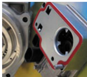
— Exakte Linienführung mit max. +/- 0,1 mm Toleranz
