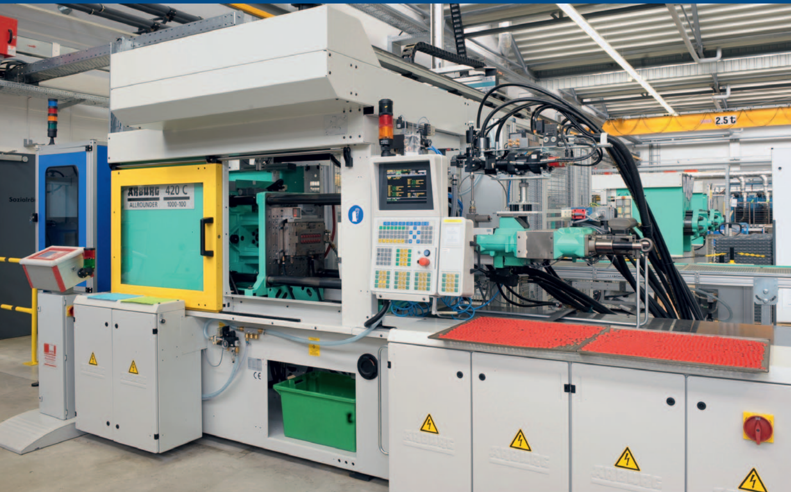
In dieser Spritzgussmaschine wird eine Silikondichtlippe an eine Edelstahlscheibe anvulkanisiert. Das Bauteil wird in ein Sitzbelegungserkennungs-System eingebaut.
